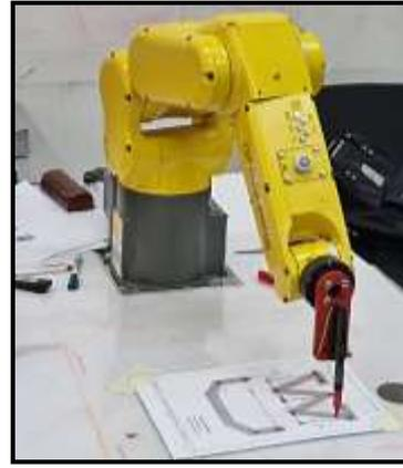
Рисунок 6. Обработка роботу FANUC рисунка на плоскости и отображение команд на светофоре.
